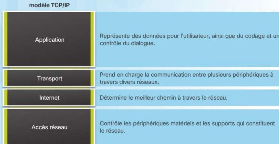
Le modèle de protocole TCP/IP pour les communications interréseaux fut créé au début des années 1970 et est appelé modèle Internet. Comme l'illustre la figure, il définit quatre catégories de fonctions qui doivent intervenir pour que les communications aboutissent. L'architecture de la suite de protocoles TCP/IP suit la structure de ce modèle. Pour cette raison, le modèle Internet est généralement appelé modèle TCP/IP.
